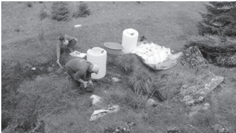
Слика 12. Припрема трасера (NaCl), понор Швабаре, мај 2016. године Figure 12. Preparation of NaCl used as tracer for the test conducted at ponor Švabare (Babine plateau), May 2016
