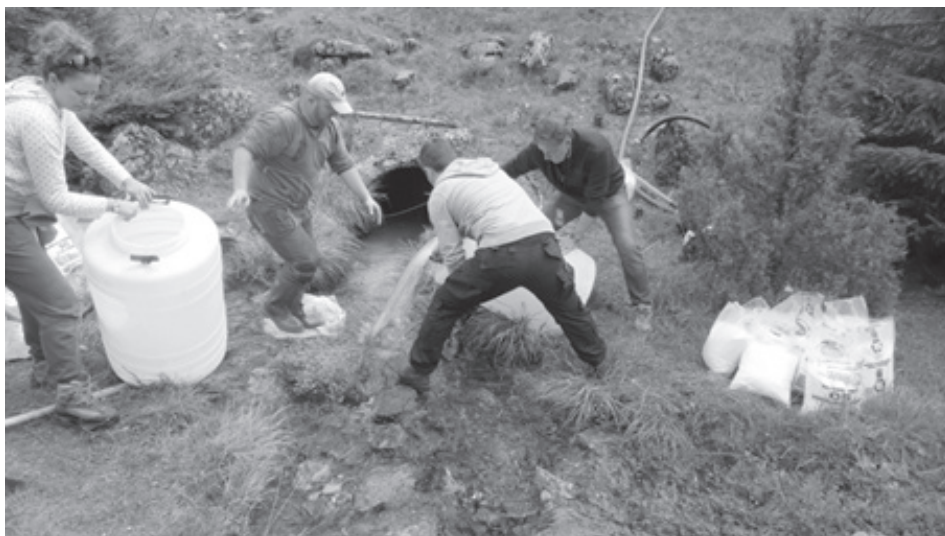
Слика 13. Наливање трасера у понор Швабаре, мај 2016. године Figure 13. Injection of tracer into ponor Švabare, May 2016
